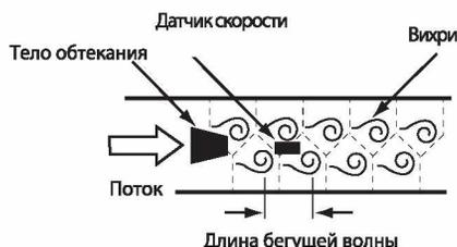
В основе принципа измерения лежит явление, именуемое вихревой дорожкой Кармана. Тело обтекания, имеющее особую форму, располагается на пути следования потока. Когда скорость потока достигает определенной величины, за телом обтекания в потоке происходит образование вихрей.
