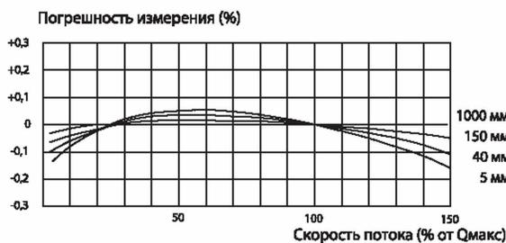
Погрешность измерения соотносится с фактической скоростью потока. На диаграмме показаны характеристики винтового расходомера модели OMG-R...Имеется сертификат испытаний, поскольку каждый прибор индивидуален.
